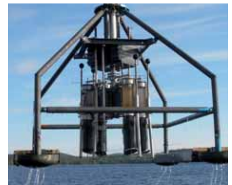
Der Multicorer kann mehrere kurze Kerne gleichzeitig ziehen. Foto: Thomas Leipe, IOW
